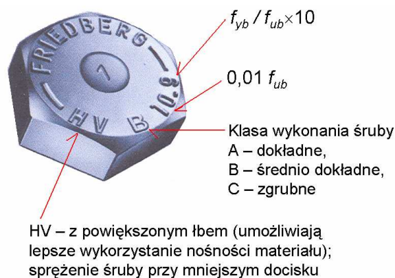
Rys. 4. Przykład symbolu znakowania śruby
